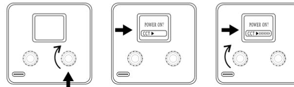
4. Правое колесико служит для изменения яркости в различных режимах. Когда на экране светится 0%, прибор находится в режиме ожидания. Вращайте колесико против часовой стрелки до погасания экрана и полного отключения. После повторного включения, прибор вернётся в тот режим, в котором он работал до выключения. Пожалуйста, отключайте питание полностью, если прибор не будет использоваться в течение продолжительного времени
