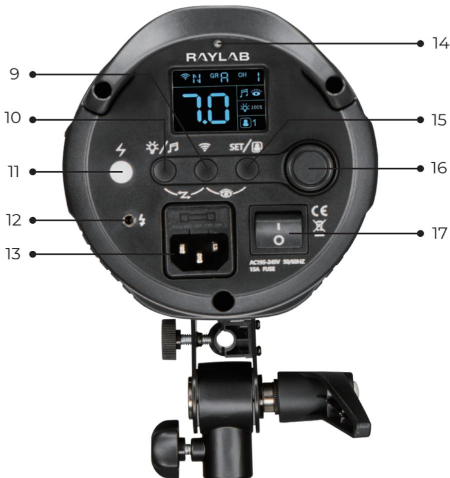
9) Кнопка включения режима беспроводного управления
